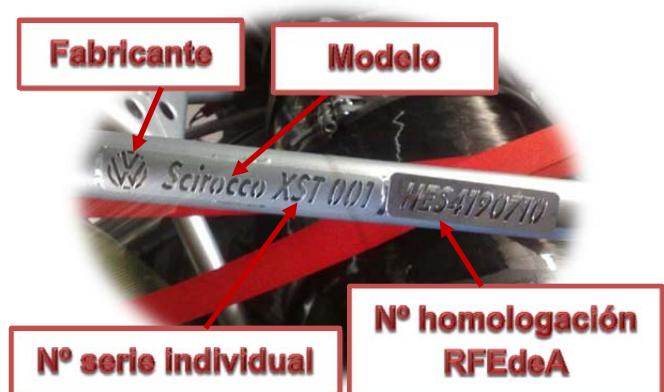
Placa de identificación troquelada sobre una placa soldada al tubo de la estructura de seguridad
