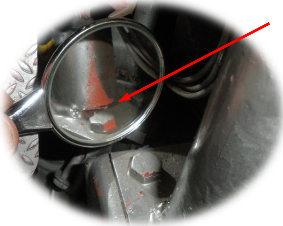
Tubo no soldado con el pie de anclaje a lo largo de todo el perímetro del tubo
